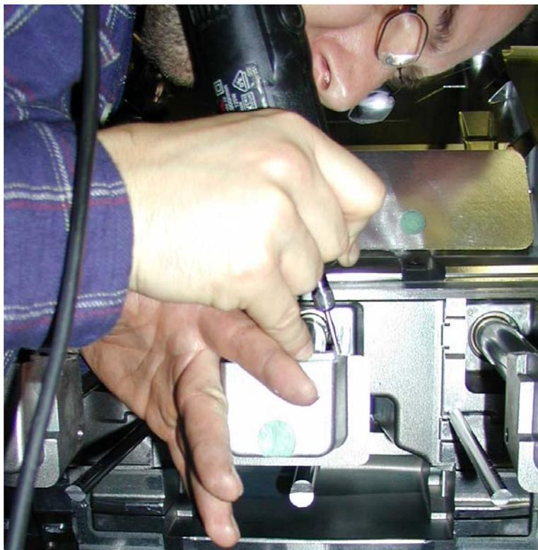
Abb. 1: Nacharbeit von Formschrägen an einem Aushebesegment
