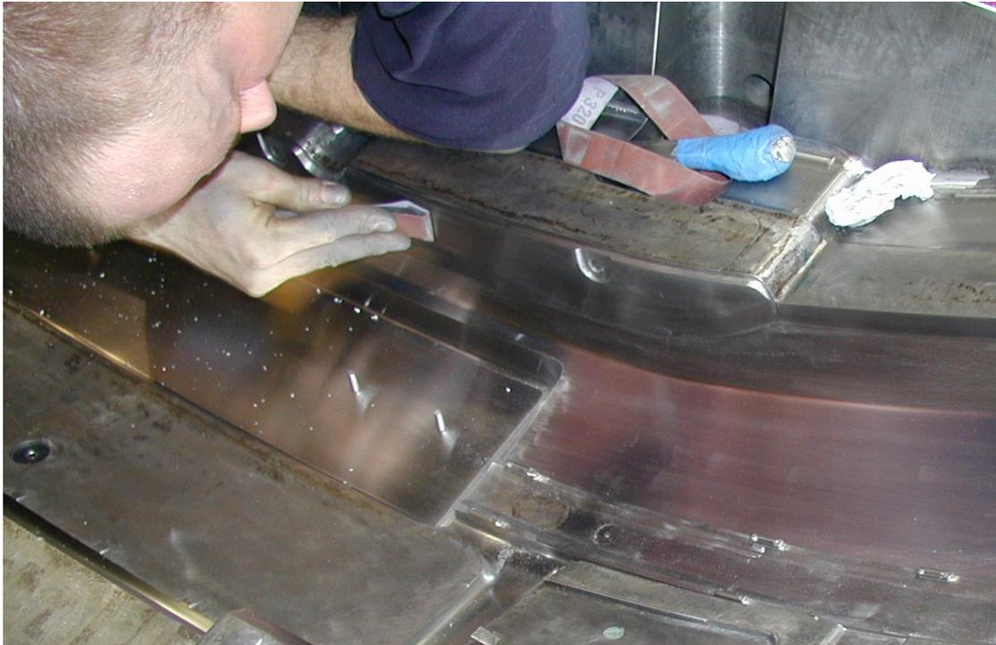
Abb. 2: Manuelle Oberflächen-Feinstbearbeitung an einem Spritzgießwerkzeug
