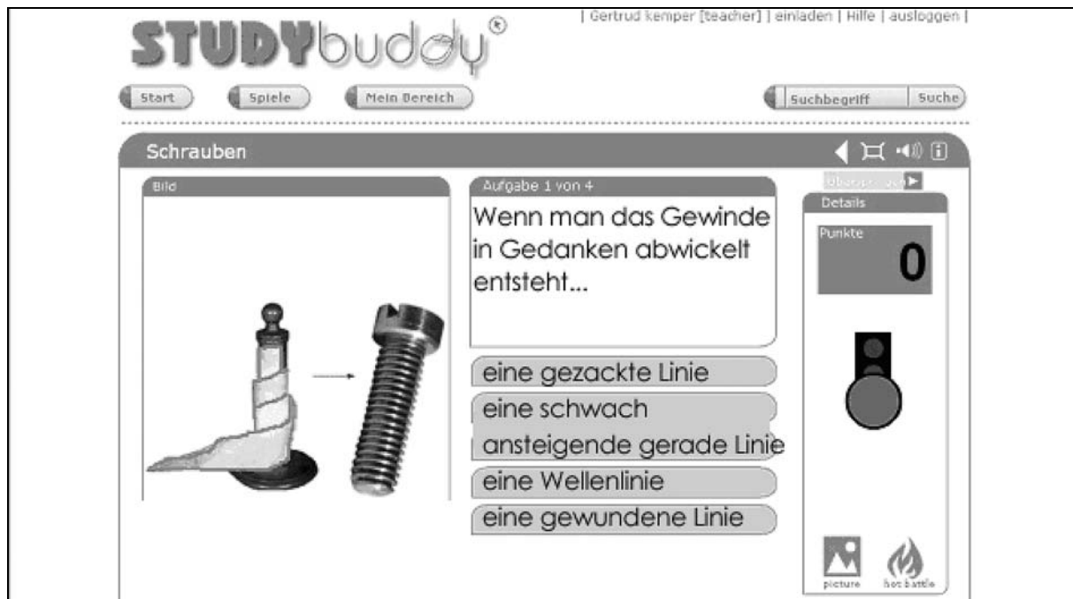
Abb. 2: Anregung einer Analogiebildung. Wenn man ein längliches Papierdreieck um einen Zylinder wickelt, entsteht eine Schraubenslinie.
