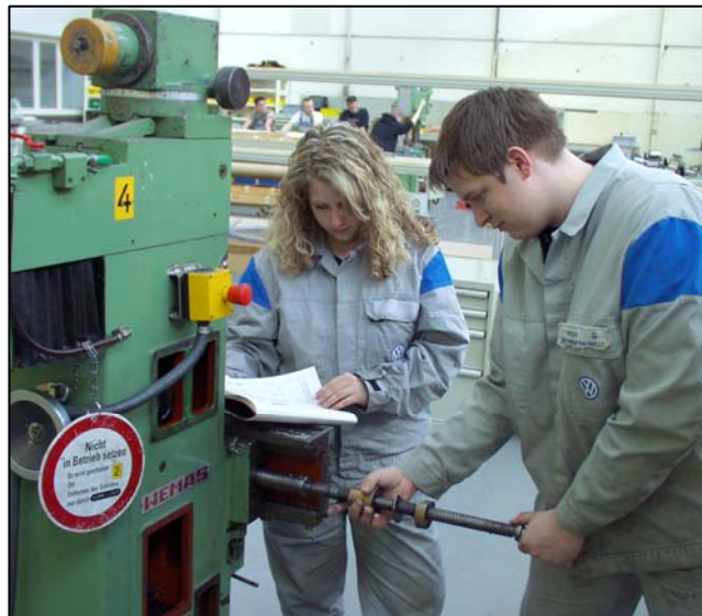
Abb. 5: Auswechseln einer Spindel
