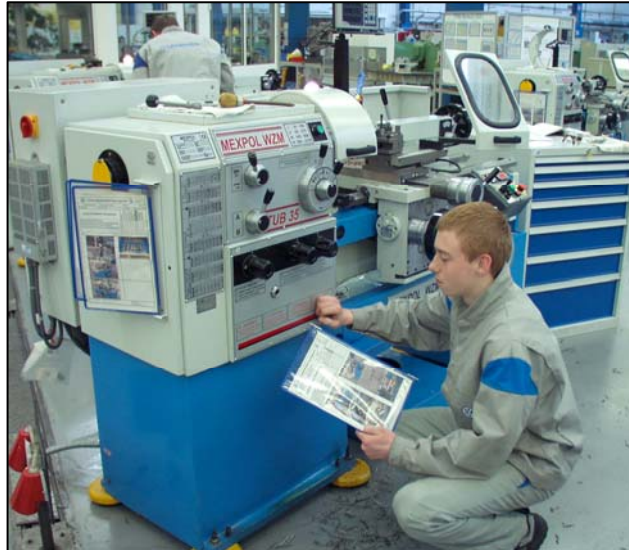
Abb. 6: Auszubildender beim Prüfen des Ölstandes
