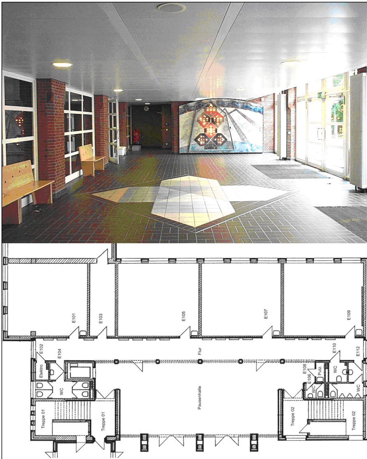
Abb. 4: Eingangshalle und Erdgeschoss-Grundrissplan des Elektrobeäudes der WLS
