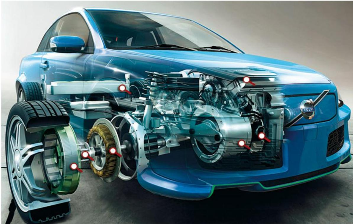
Abb. 3: Elektrischer Radnabenantrieb der nächsten Fahrzeuggeneration
