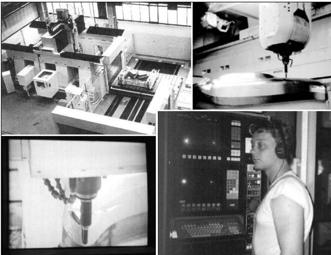
Abb. 4: HSC-Bearbeitungszentrum im Großwerkzeugbau (o. l.) mit integrierter Videokamera im Arbeitsraum (o. r.) zur Wiedergabe des Bearbeitungsvorganges auf einem separaten Bildschirm (u. l.); Maschinenarbeiter mit Kopfhörer zur akustischen Kontrolle der Zerspanungsvorgänge während der Prozessbeobachtung am Bildschirm (u. r.) (VOLLMER u. a. 1998, S. 177 ff)
