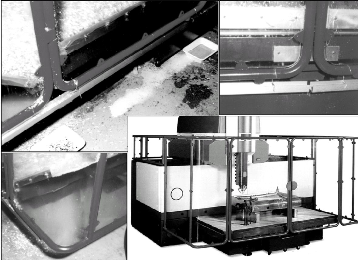
Abb. 1: Die filigrane Gestaltung der Kapselung dieser HSC-Maschine (u. r.) vermag nicht die Späne und Kühlschmierstoffe zurückzuhalten, so dass zusätzliche Ableitbleche (u. l.), Auffangrinnen (o. r) und -schalen (o. l) erforderlich wurden, um die Verschmutzung des Arbeitsbereichs zu begrenzen (VOLLMER u.a. 1998, S. 168 ff)
